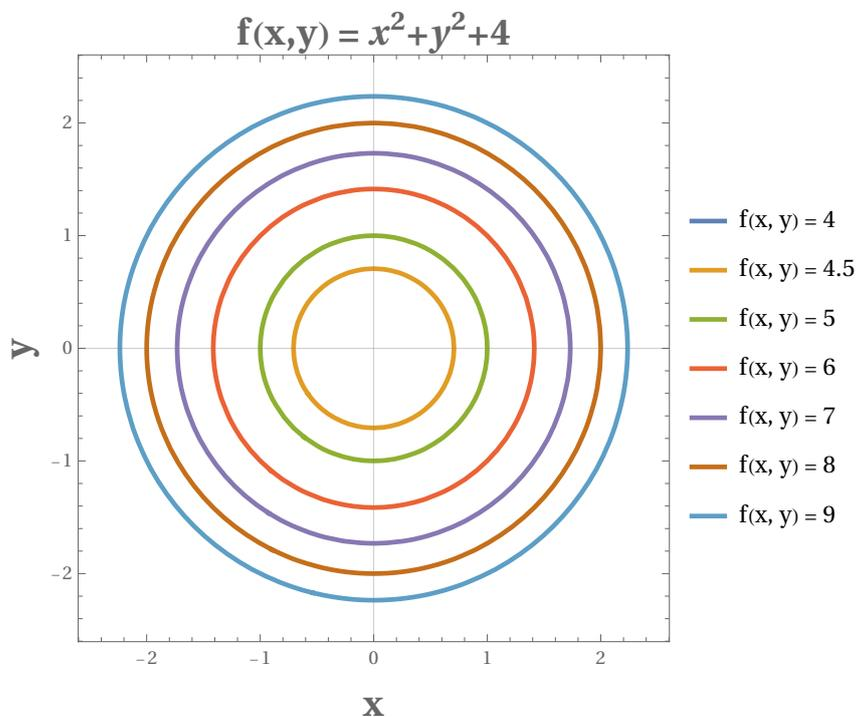
Figura 9: Curve di livello della funzione  $f(x, y)$  per vari valori di  $k$
